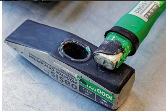
Ключевым параметром молотка является стягивающее усилие, то есть насколько крепко рукоятка держится в металлической головке. «Деревянные» молотки не в силах тягаться с фиберглассом. Конструктивно последние сделаны со специальными замками, которые чаще всего очень хорошо противостоят вырыву
