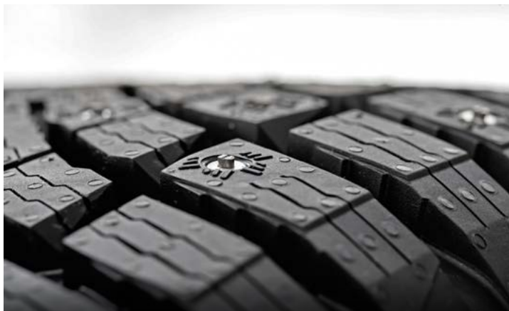
В центральном и плечевой зонах протектора шины Ikon Autograph Ice 10 применены шипы двух видов
