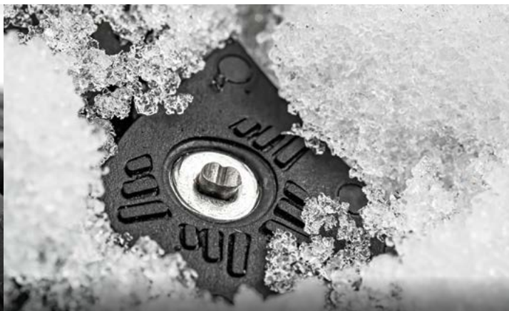
В центральном и плечевой зонах протектора шины Ikon Autograph Ice 10 применены шипы двух видов
