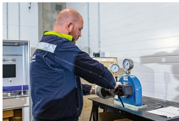
Так происходит затяжка стэнда специальным ключом. Выставлено значение открутки 800 Нм. Справились все гайковерты, но некоторые с большим трудом.
