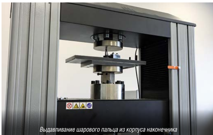
Вырыв шарового пальца из корпуса наконечника
