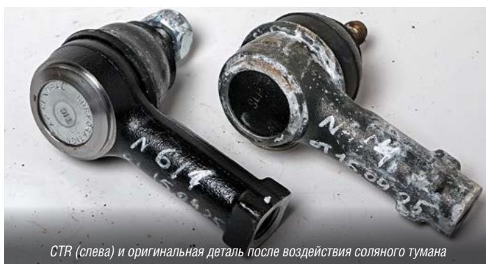
Образцы после испытания на коррозионную устойчивость
