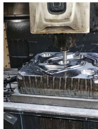
Изготовление пресс-формы рычага подвески для Dodge Nitro и Jeep Cherokee
