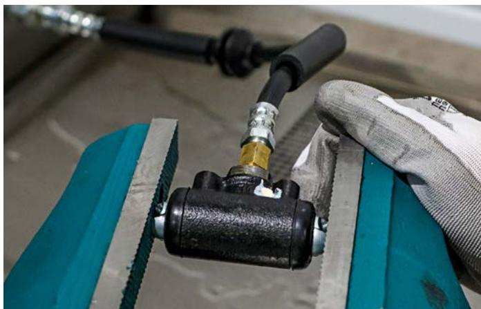
Тормозной цилиндр функционирует за счет наличия в нем тормозной жидкости. Соответственно, очень важным фактором работоспособности цилиндра является его **герметичность**, чтобы эта самая жидкость не покидала его пределы. Этот параметр мы и проверили в первую очередь. Однако никаких шокирующих выводов на первом этапе испытаний сделать не удалось: на специальном стенде проверки герметичности тормозных цилиндров MS-300 абсолютно все участники испытаний справились с задачей на отлично.
