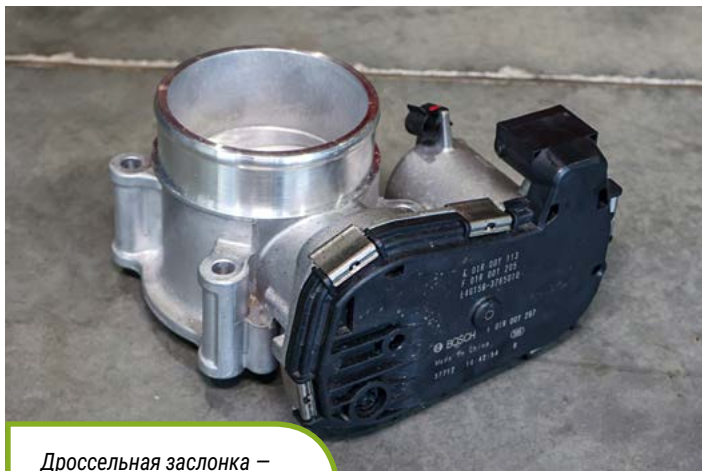
Дроссельная заслонка — с маркировкой китайского подразделения Bosch
