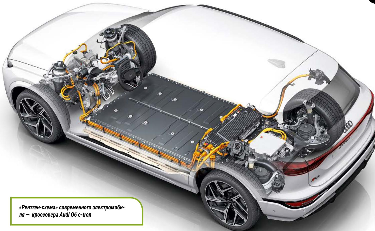
«Рентген-схема» современного электромобиля – кроссовера Audi Q6 e-tron
