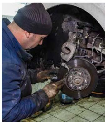
полностью, свою функцию он выполнять уже не в состоянии. Такие отложения свидетельствуют о том, что состав колодок достаточно щадящий для тормозных дисков, в меру пыльный, смесь подобрана оптимально. Само феродо имеет едва заметные полосы износа, не имеет каверн и сколов, что также вполне хороший результат для аналога. Следует обратить внимание на то, что тормозные колодки оборудованы «скрипунами» (механическими датчиками износа)».
