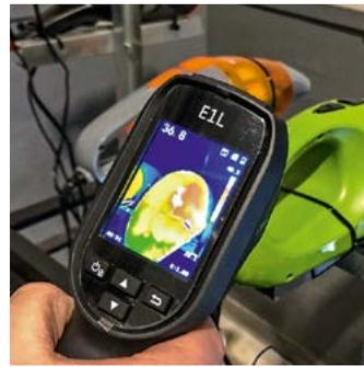
После снятия вакуумной и расходной характеристик мы испытывали пылесосы холодом и жарой.
