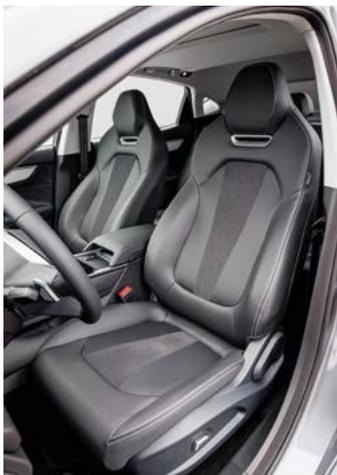
*Передние сиденья «шестого» «Москвича» удобны с точки зрения профиля спинки и радуют удачным подбором материалов обшивки. Но огорчают узкими диапазонами регулировок*
