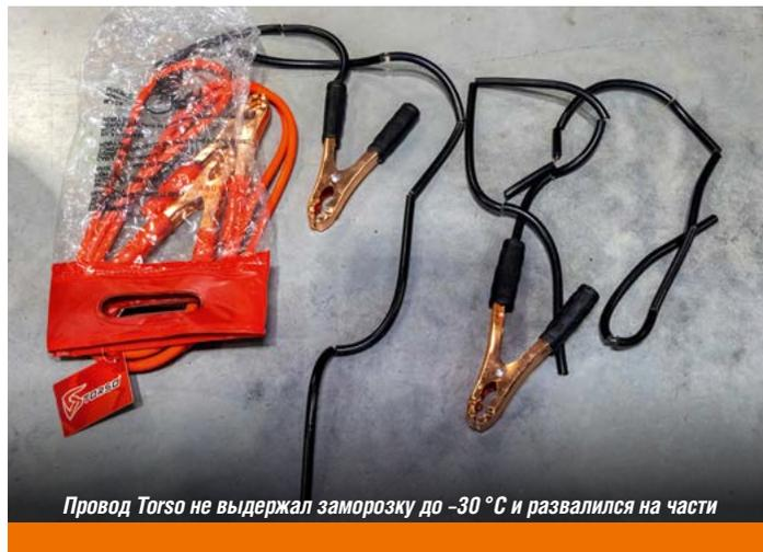
Провод **Torso** не выдержал заморозку до  $-30^{\circ}\text{C}$  и развалился на части
