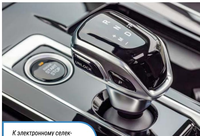
*К электронному селектору трансмиссии нужно привыкнуть: поначалу запросто можно перепутать кнопки разблокировки рычажка и включения режима Parking*
