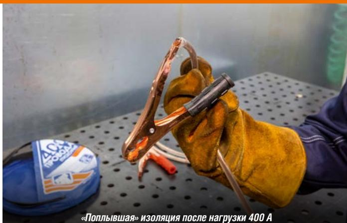
«Поплывшая» изоляция после нагрузки 400 А
