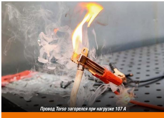
Провод Torso загорелся при нагрузке 107 А
