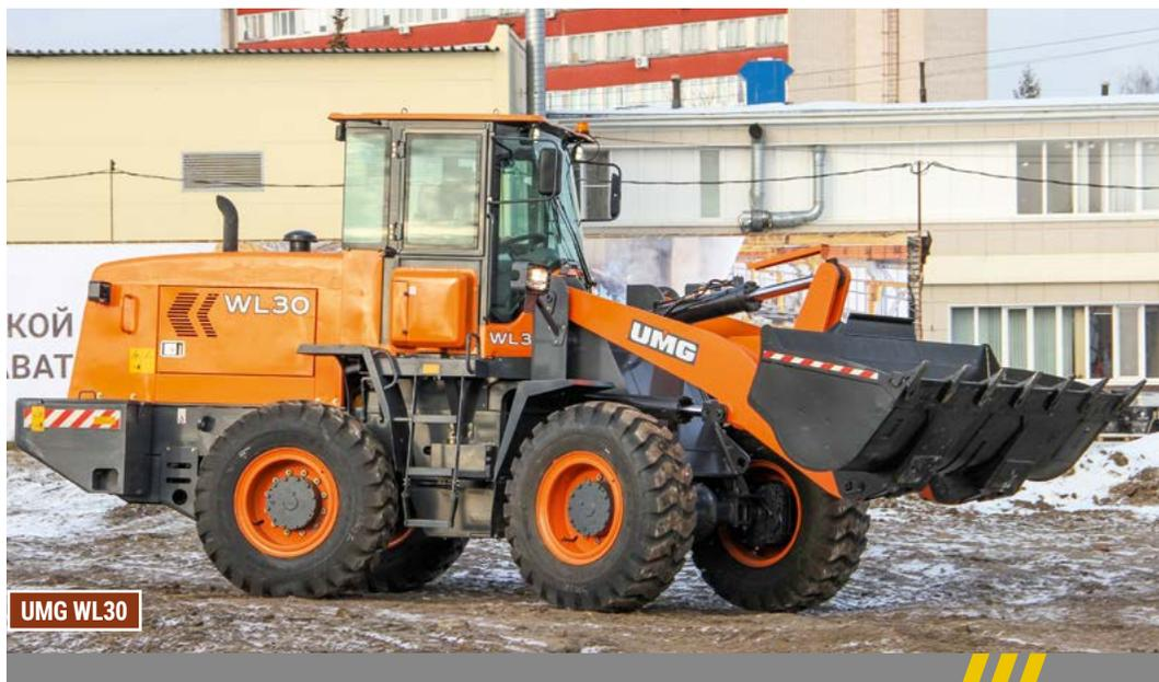
ся российский двигатель ЯМЗ-534 мощностью 99 л. с. В коробке передач четыре передачи вперед и три назад. Скорость передвижения по шоссе — до 40 км/ч. Имеется подключаемый привод переднего моста. В качестве погрузочного оборудования используется многофункциональный челюстной ковш «семь в одном». Максимальная грузоподъемность — 3058 кг. Емкость погрузочного ковша — 1,0 куб. м.
