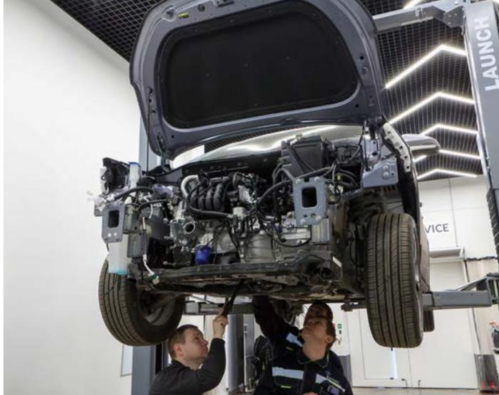
мых поздних этапах сборки, хотя обычно этот процесс происходит в начале конвейера. Да и нанесение герметика не назовешь равномерным. Где-то на днище его много, а в каких-то местах — как будто прошлись почти сухой кисточкой. То же самое можно сказать и об антикоррозийном покрытии. Она где-то есть, а где-то отсутствует — без какой бы то ни было логики в процессе нанесения.
