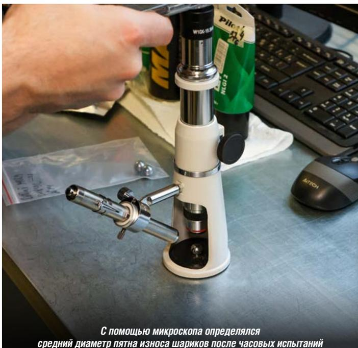
С помощью микроскопа определялся средний диаметр пятна износа шариков после часовых испытаний
