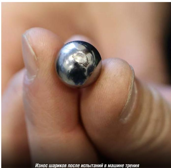
Износ шариков после испытаний в машине трения
