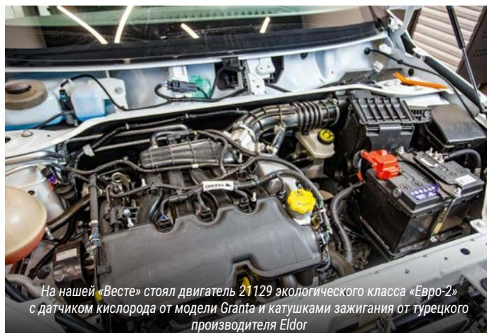
На нашей «Весте» стоял двигатель 21129 экологического класса «Евро-2» с датчиком кислорода от модели Granta и катушками зажигания от турецкого производителя Eldor
