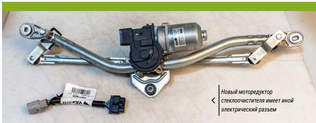
Новый моторредуктор стеклоочистителя имеет иной электрический разъем
