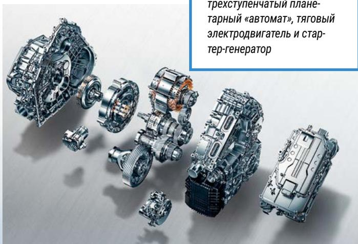
В корпусе трансмиссии DHT (Dedicated Hybrid Transmission) объединены трехступенчатый планетарный «автомат», тяговый электродвигатель и стартер-генератор
