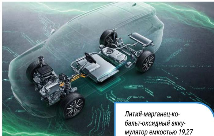
Литий-марганец-кобальт-оксидный аккумулятор емкостью 19,27 кВт·ч заключен в корпус алюминиевого модуля, который не только защищает от механических повреждений, но и поддерживает оптимальную температуру ячеек
