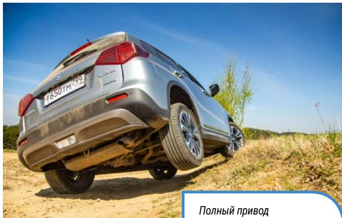
*Полный привод на Suzuki Vitara работает корректно, муфта замыкается без рывков и посторонних звуков, а кузов автомобиля отличается похвальной жесткостью: при диагональном вывешивании багажник открылся и закрылся без проблем*
