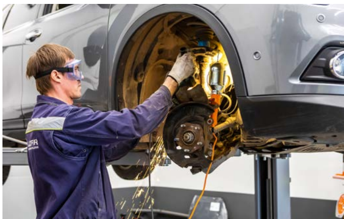
В подвеске под замену просились оба рулевых наконечника, стойки стабилизатора, рулевые тяги и задние сайлентблоки передних рычагов
