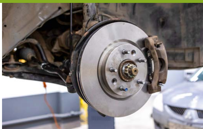
Запчасти, выбранные нами на замену изношенным: детали рулевого управления CTR, сайлентблоки Jikiu, тормозные диски и колодки Trialli
