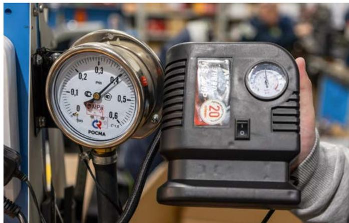
накачать колесо. Первый подопытный – компрессор **Stvol** – сумел спокойно запуститься и без труда накачать колесо, вот только манометр насоса замерз так, что выяснить, до какого давления накачана шина, не представлялось возможным.
