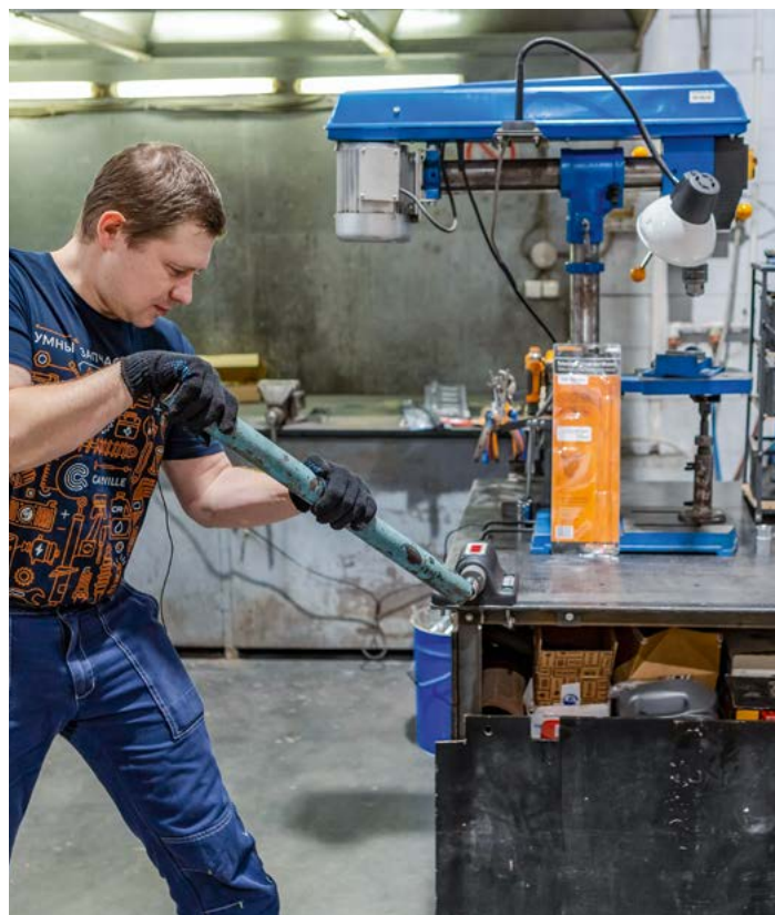
Наиболее частым типом повреждения инструмента при испытаниях на максимальный выдерживаемый крутящий момент была деформация посадочного квадрата
