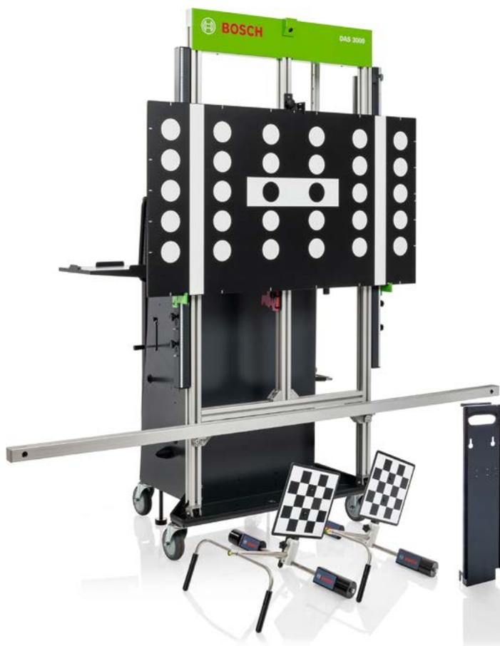
KTS. Автомобиль идентифицируется в ПО ESI[tronic], после чего все системы проверяются на наличие ошибок. Перед началом калибровки мишени центрируются согласно инструкциям, предоставляемым программным обеспечением.
