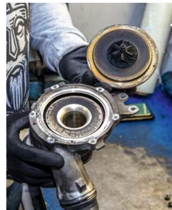
равно будет выходить из строя. В нашем случае крыльчатка турбокомпрессора внешних дефектов не имеет — этот элемент можно будет установить повторно.
