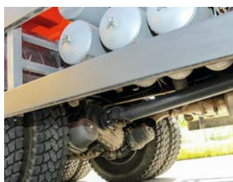
Тормозные механизмы барабанного типа с автоматической регулировкой зазоров. В тормозной системе присутствует ABS
