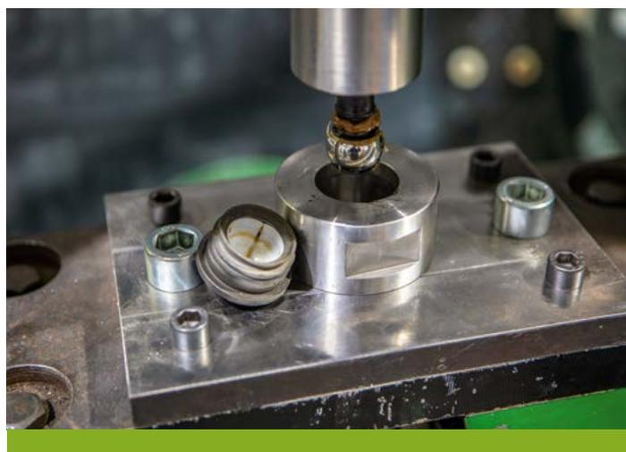
По сложившейся традиции мы превышаем обязательные требования ГОСТа в отношении опор и обязательно проверяем устойчивость к морозу специального защитного пыльника, который служит для предотвращения попадания пыли, воды и грязи в шарнир.
