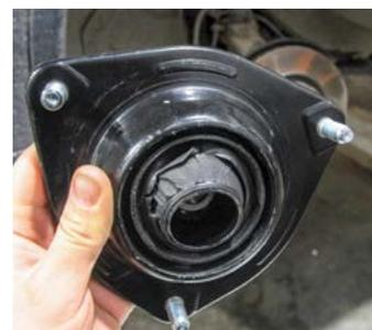
^ *На фото выше выдавленная втулка опоры амортизатора.*
