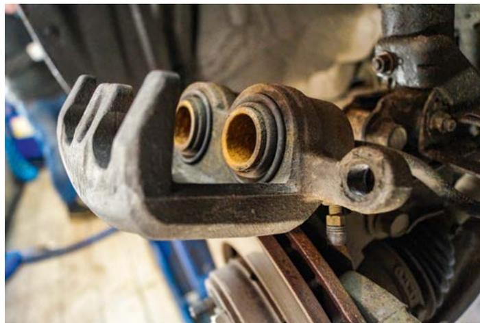
*Обычный мультибрендовый сервис часто относится к особенностям обслуживания тормозной системы без погружения в проблемы. Типовые ошибки при обслуживании — применение неподходящих смазок и промывок, что может привести к разбуханию и разрушению манжет и пыльников.*
