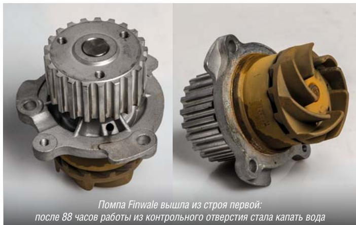
Помпа Finwhale вышла из строя первой: после 88 часов работы из контрольного отверстия стала капать вода
