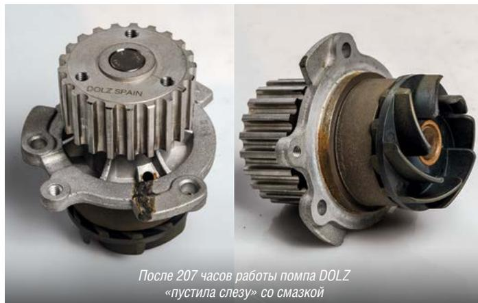
После 207 часов работы помпа DOLZ «пустила слезу» со смазкой
