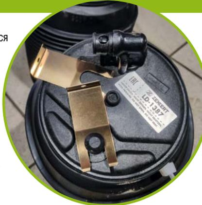
баллонов в нижней части из-за налипания грязи на посадочное место стакана в районе складки пневмобаллонов (одно из самых уязвимых мест). В образовавшиеся микротрещины уходил сжатый воздух, который должен был «поддерживать» автомобиль.
