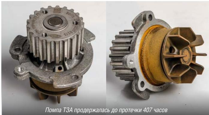
Помпа ТЗА продержалась до протечки 407 часов
