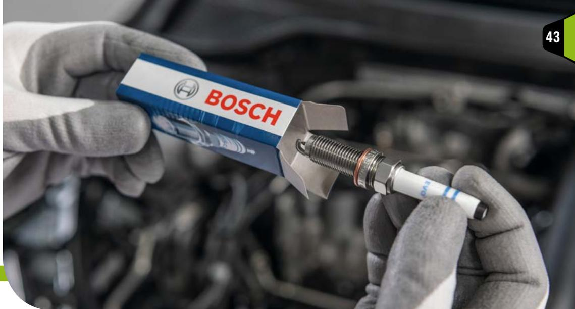
После извлечения отработавшей свечи по ее внешнему виду можно определить, правильные ли у мотора настройки впрыска и зажигания. Если с двигателем, топливом или даже свечой зажигания что-то не так, на последней появляется характерный нагар — с его помощью специалисты сразу могут определить причину неисправности и ускорить ремонт.
