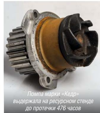
Помпа марки «Кедр» выдержала на ресурсном стенде до протечки 476 часов
