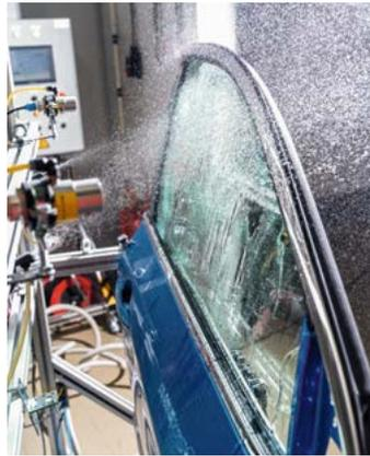
пример, уплотнители, хромированные накладки и лакокрасочное покрытие подвергаются химической обработке, имитирующей агрессивную уличную среду.
