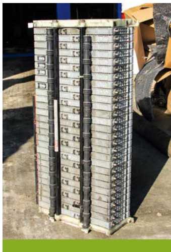
Батарея Toyota Prius состоит из 28 элементов, каждый из которых можно заменить отдельно
