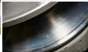
^ | Пример повреждения конусов вариатора
