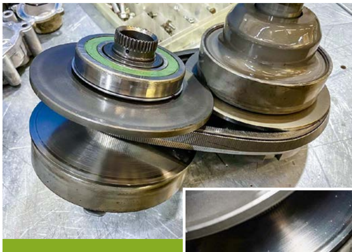
^ | Пример повреждения конусов вариатора
