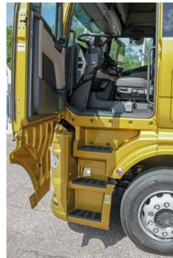
Для улучшения доступа в кабину задействованы ступеньки с противоскользящим покрытием. Сама лестница максимально смещена к середине дверного проема. Дверь распахивается на 89 градусов, при этом расстояние между поручнями составляет 760 мм
