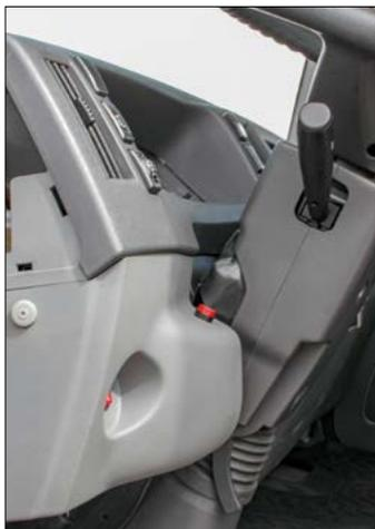
Диссонансом слева от рулевой колонки выглядят две красные кнопки: включение питания гидроборта и освещения грузового пространства фургона
