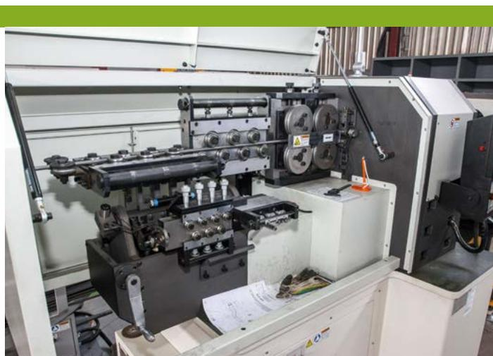
когибе — подобного оборудования, как заявляют в Trialli, в России больше нет. Машина работает в автоматическом режиме, проволока для кронштейнов подается в бухте. Производственная мощность такого станка — более 3,5 тыс. кронштейнов в день. Кирилл Шипота: «Мы сейчас получаем довольно большое количество сторонних заказов на такие детали, есть также предварительная договоренность о поставке кронштейнов в Европу».
