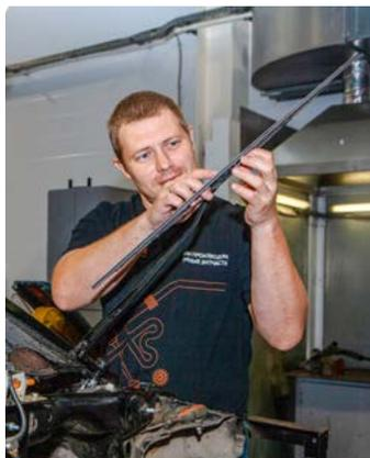
Проверка качества очистки при ходе вверх показала, что большинство щеток очищают стекло с огрехами при ходе вверх, но при обратном ходе убирают оставленную воду. Для проведения следующих этапов теста от каждого бренда отбираются образцы с наилучшими параметрами очистки. Именно им и предстоит выдержать дальнейшие испытания.
