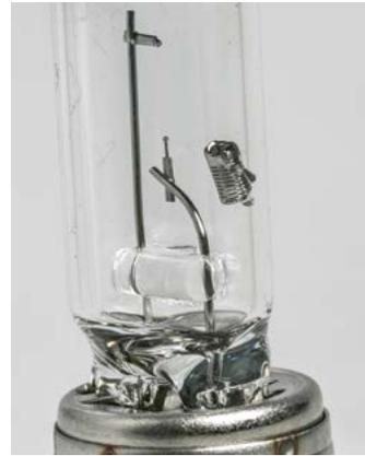
У одной из четырех лампочек Bosch Longlife Daytime при попытке подключить ее к стенду взорвалась спираль. Либо это производственный брак, либо повреждение при транспортировке — этого мы уже не узнаем
