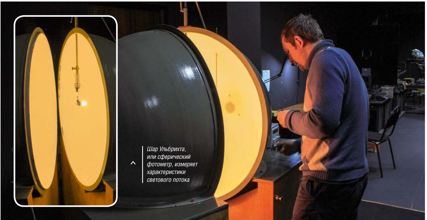
Шар Ульбрихта, или сферический фотометр, измеряет характеристики светового потока
