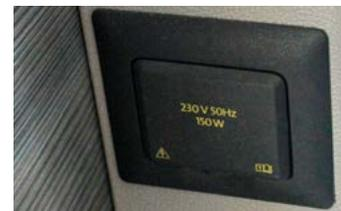
За спинкой водительского кресла находится блок розеток: евростандарт на 230 В, автомобильная увеличенной мощности на 20 В и полноценная на 220 В. Кроме того, по всей машине разбросаны еще три розетки на 12 В. И это не считая розетки и двух USB-портов в кабине
