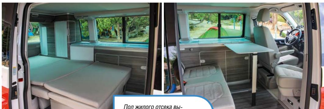
Пол жилого отсека выстелен ламинатом, который очень легко моется и не царапается. Под полом находится автономная печка, работающая на солярке из основного бака. Интересно, что печка бесшумная: тепло выделяется за счет химического расщепления топлива
