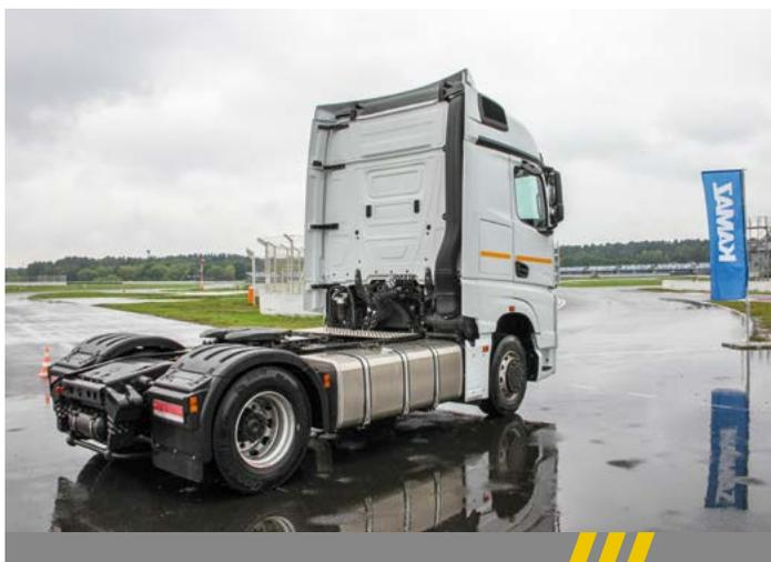
ная кабина для магистрального грузовика появилась только после начала плотного сотрудничества с концерном Daimler AG в рамках проекта СП «Даймлер КАМАЗ Рус». Впрочем, как и ведущие мосты, и много чего еще. Роботизированная коробка передач адаптирована совместно с компанией ZF. Рядный дизельный силовой агрегат создавался хоть и с нуля, однако совместно с компанией Liebherr.
