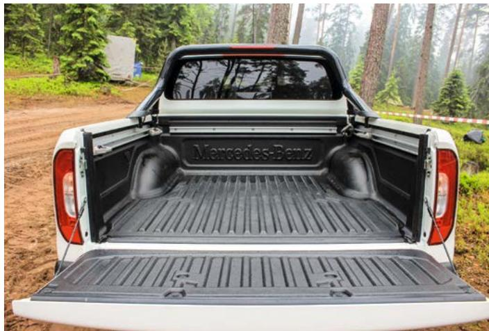
Размер грузовой платформы X-Class — 1587х1560х431 мм. Это меньше, чем у многих конкурентов. Особенно мала высота бортов. Грузоподъемность среднестатистическая — 900 кг, что позволяет въезжать в центр Москвы. Пластиковый кожух в кузов и дуги — дополнительные опции. Можно заказать также несколько вариантов крышек или КУНГов, но цены на них немалые: от 177 000 до 347 000 рублей
