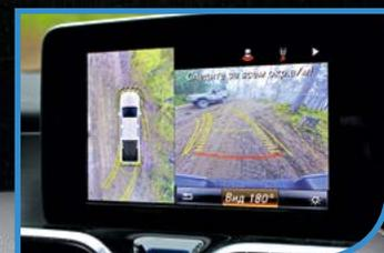
Фирменная система кругового обзора радует наглядностью. На щитке приборов дублируются дорожные знаки. Система удержания в полосе только предупреждает о выходе за разметку. На месте и фирменный джойстик круиза — увы, не активного. Штатная навигация идет за доплату 45 580 рублей
