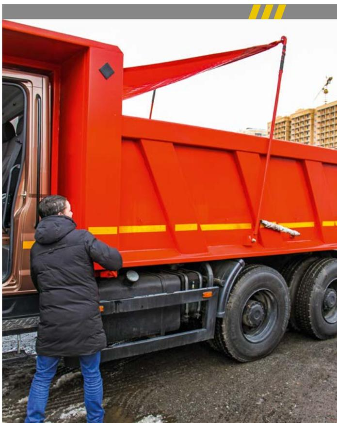
топливный бак на 350 литров, рядом с ним — бачок гидросистемы самосвала. Оба — за боковой защитой.
