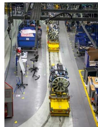
лельно идет подборка подвесок: передних, задних и поддерживающих мостов, карданных передач. На отдельном участке идет подготовка силового агрегата — двигатель стыкуется с коробкой передач. Готовые узлы и агрегаты отправляются на главный конвейер.
