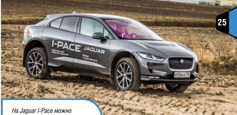
На Jaguar I-Pace можно относительно спокойно сунуться на легкое бездорожье. Опциональная пневмоподвеска (в базе клиренс фиксирован на уровне 154 мм) может поднять кузов на 204 мм над землей, сохраняя приличные хода. Активный круиз имеет ползующий режим, а от диагонального вывешивания спасает грамотная работа полноприводной трансмиссии. Днище абсолютно плоское и полностью закрыто алюминиевым листом
