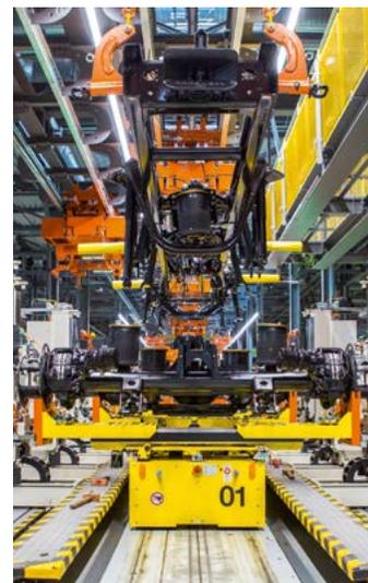
Кратко технология сборки тяжелого грузовика выглядит следующим образом. Все начинается со сборки рамы. Готовая рама окрашивается, затем поступает на арматурный участок. Здесь прокладываются трубопроводы и электропроводка, устанавливаются аккумуляторные ящики и выпускная система. После чего рама на робокаре отправляется на линию сборки грузовика. Парал-
