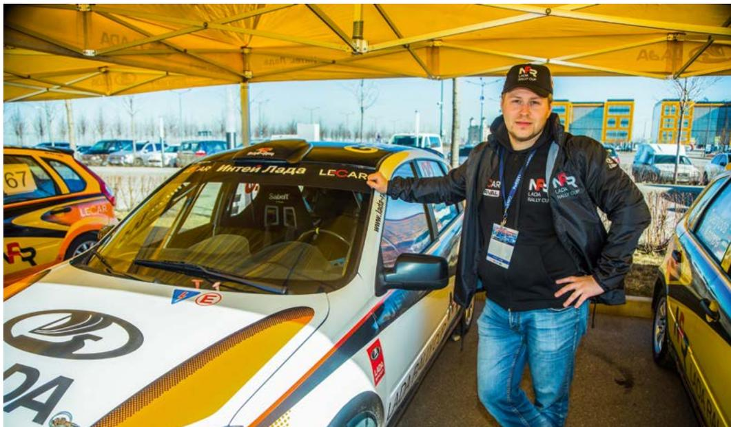
Гоночный автомобиль Lada Rally Cup — это Lada Kalina NFR R1, а с 2019 года — Lada Granta R1. Машина профессионально подготовлена по всем правилам РАФ по классу «Национальный», системы безопасности омологированы FIA. Болид имеет двигатель ВАЗ 1.6 мощностью 160 л.с., передний привод и 5-ступенчатую механическую коробку передач. Стоимость новой машины превышает 1 300 000 рублей
