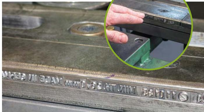
Каждый тормозной диск маркируется. Первые четыре цифры — это номер, указывающий, для какого автомобиля он выпущен, дальше — номер заводской смены, то есть кто конкретно и когда его сделал, и в конце — минимально допустимая толщина
