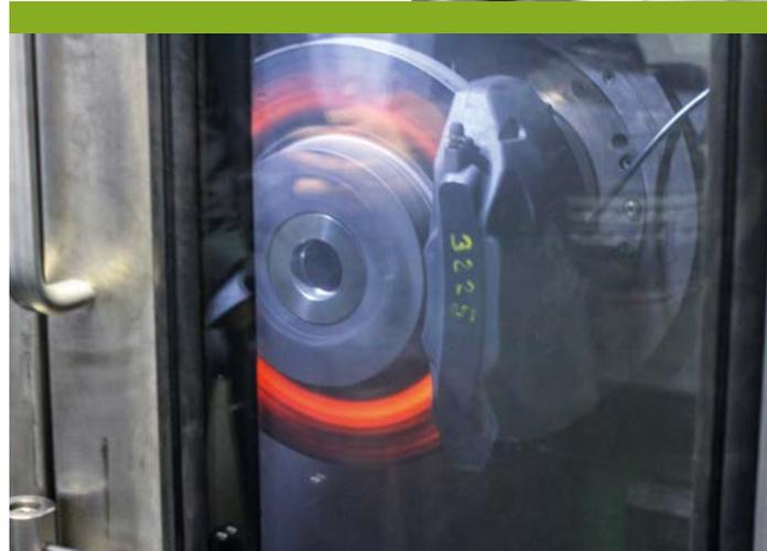
На испытательном стенде прототип диска Zimmermann совмещается с оригинальным суппортом и оригинальными колодками, после чего проходит серия циклов имитации всех возможных вариантов торможения, а также программа имитации условий частичного или полного разрушения диска
