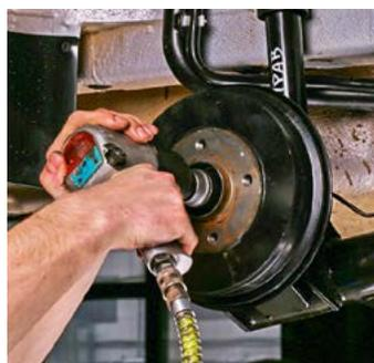
требуют более высокой точности исполнения компонентов и более дорогостоящих фрикционных материалов. Зато запас по росту тормозного усилия и тормозной мощности у них намного выше. Сжать сплошной или вентилируемый диск можно намного сильнее, чем разжать барабан. К тому же рабочая поверхность диска и колодки интенсивно обдувается воздухом, а, сделав диск вентилируемым, мощность можно еще увеличить.
