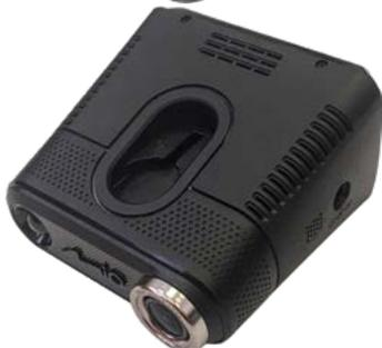
возникнуть проблемы с управлением. На внешней панели расположены «глазок» лазерного приемника, объектив камеры регистратора и антенна для детекции камер фото- и видеозаписи.
