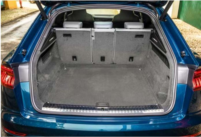
У багажника достойный для класса объем 605 литров. Под полом — сдутая «докатка» и батарея гибридного привода. Электрозамком можно управлять взмахом ноги под бампером
