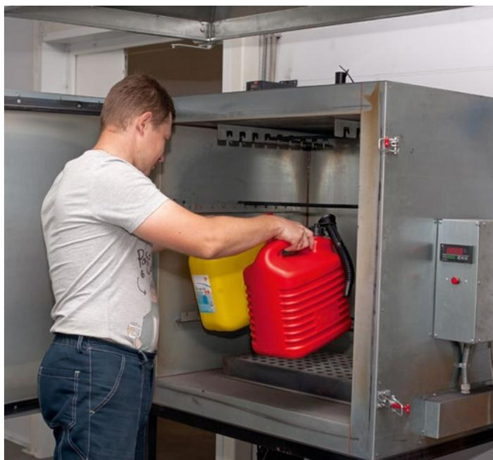
быть заполнены на 98% от максимальной вместимости, затем канистра с ее содержимым должна быть заморожена до  $-18^{\circ}\text{C}$ , после чего тару диагонально роняют на испытательную площадку с заданной высотой. Высота нормируется исходя из класса опасности вещества, для которого предназначена тара. Бензин относится ко II классу, для него высота составляет 120 см.
