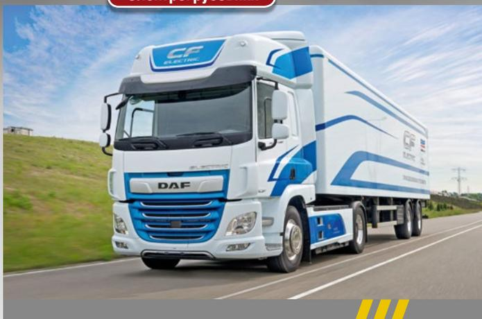
создан на базе универсальной серии DAF CF. В его конструкции используется технология VDL E-Power, обеспечивающая работу исключительно от электропривода. Центром интеллектуального силового агрегата выступает электродвигатель 210 кВт (пиковая мощность 240 кВт), питаемый от блока литийионных аккумуляторов отдачей 170 кВтч.
