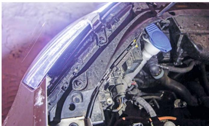
*И ксеноновые, и светодиодные фары в обязательном порядке штатно оснащаются автокорректором и омывателем фар. Без этих двух опций эксплуатация автомобиля с таким светом считается незаконной*
