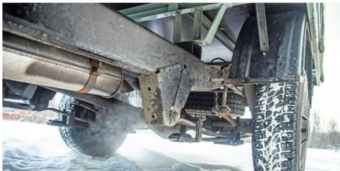
*Для увеличения грузовых возможностей рама в середине была удлинена на полметра с помощью проставки и усилена дополнительными поперечинами. Кроме того, для заднеприводной версии изготовили новую переднюю ось с другими поворотными кулаками и рулевой трапецией. Задний мост также усилили*
