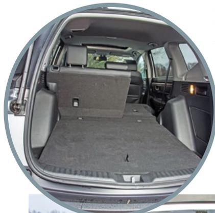
Багажный отсек также радует заботливого семьянина: приличные 522 литра номинального объема, регулируемая высота пола, рычажки для трансформации дивана и абсолютно ровная поверхность при их складывании
