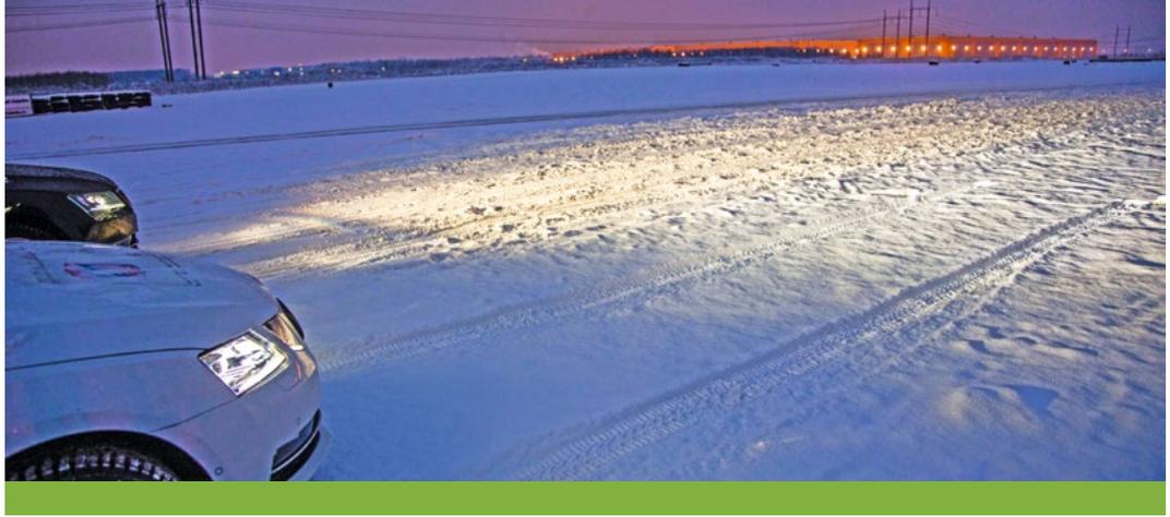
эффективны: основное полотно дороги подсвечено идеально на расстоянии порядка 30 метров, а хорошая видимость наблюдается вплоть до второго конуса (50 метров). При этом светотеневая граница проходит немногим дальше.
