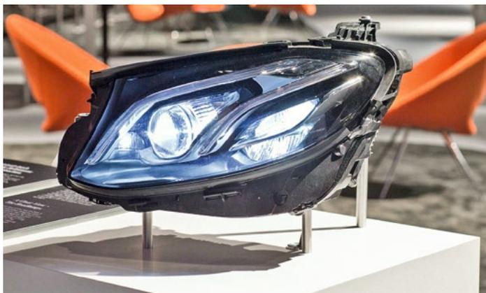
На практике в оптике Audi Matrix LED с 25 светодиодами адаптивного освещения они собраны в сменные модули по пять светодиодов в каждом, и еще пять модулей используются для статического освещения — ближнего света и статического бокового. В следующем поколении оптических систем Hella, которые с 2016 года устанавливаются на машины Mercedes, применяется целых 84 светодиода на единой плате.
