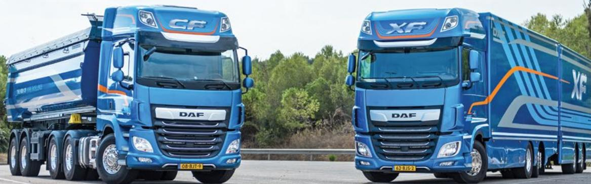
оптимальной аэродинамики всего грузового автомобиля, включая моторный отсек. Новые затворы решетки радиатора снижают сопротивление, в то время как новые заглушки между кабиной и шасси позволяют обеспечить наилучшую аэродинамику.
