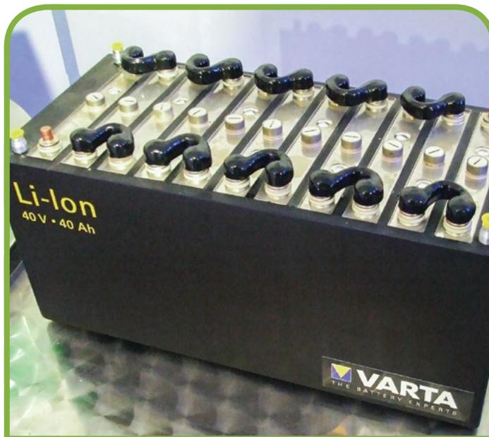
шие значения саморазряда, высокая плотность энергии, небольшие габариты аккумуляторов и полное отсутствие обслуживания на протяжении жизненного цикла.
