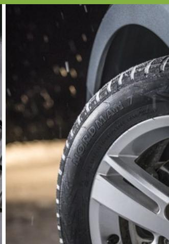
Помимо премиальной серии Hakkapeliitta 9, финны выводят на рынок и новую среднеценную линейку зимних шин Nordman 7 и 7 SUV с якорными шипами типа Air Claw. По сути, это та же Hakkapeliitta 7, только с измененным составом смеси. Типоразмеры — от 13 до 20 дюймов. Кроме того, в продаже остается и вся предыдущая гамма зимних покрышек Hakkapeliitta 8 и Nordman 5. Причем на все покрышки Nokian распространяется расширенная гарантия
